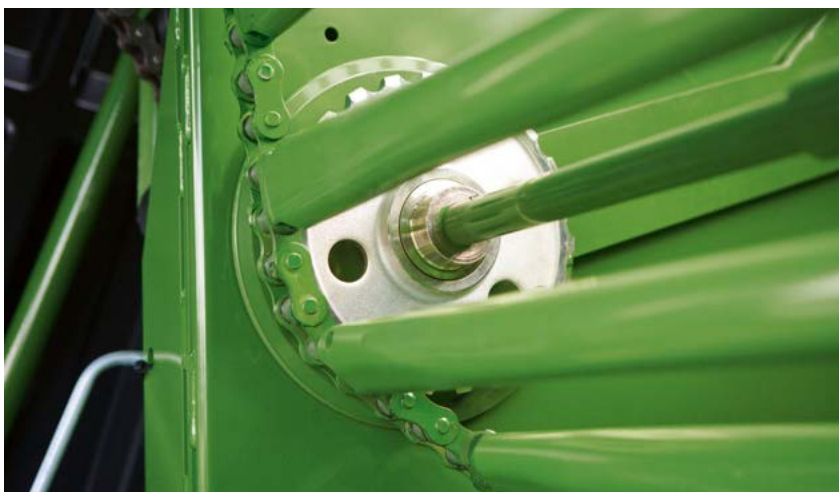
Направляющий ролик с цепочно-планчатым транспортером (Fortima с переменной прессовальной камерой)
