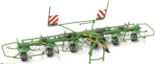
Роторные ворошители-вспушиватели KW 6.02, 6.72, и 7.82 с шестью роторами и шириной захвата 6,00 м, 6,70 м и 7,80 м идеально подходят для обработки за один проход сразу трех валков, образованных косилкой. При этом колеса трактора не наезжают на уложенную косилкой кормовую массу. Оптималь-
