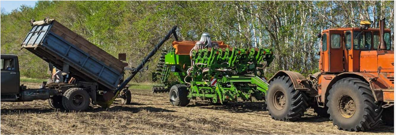
Große Einfüllöffnung zum Befüllen mit Frontladern und Befüllschnecken.
