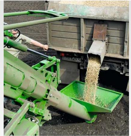
Um den Behälter der Primera DMC mit Saatgut und Dünger zu befüllen, bietet AMAZONE eine hydraulisch angetriebene Befüllschnecke an. Damit lassen sich die Befüllzeiten auf bis zu acht Minuten reduzieren und die Arbeitsleistung der Maschine dementsprechend weiter erhöhen. Die Befüllschnecke ist für alle Primera DMC 6000-2/6000-2C und 9000-2/9000-2C verfügbar.
