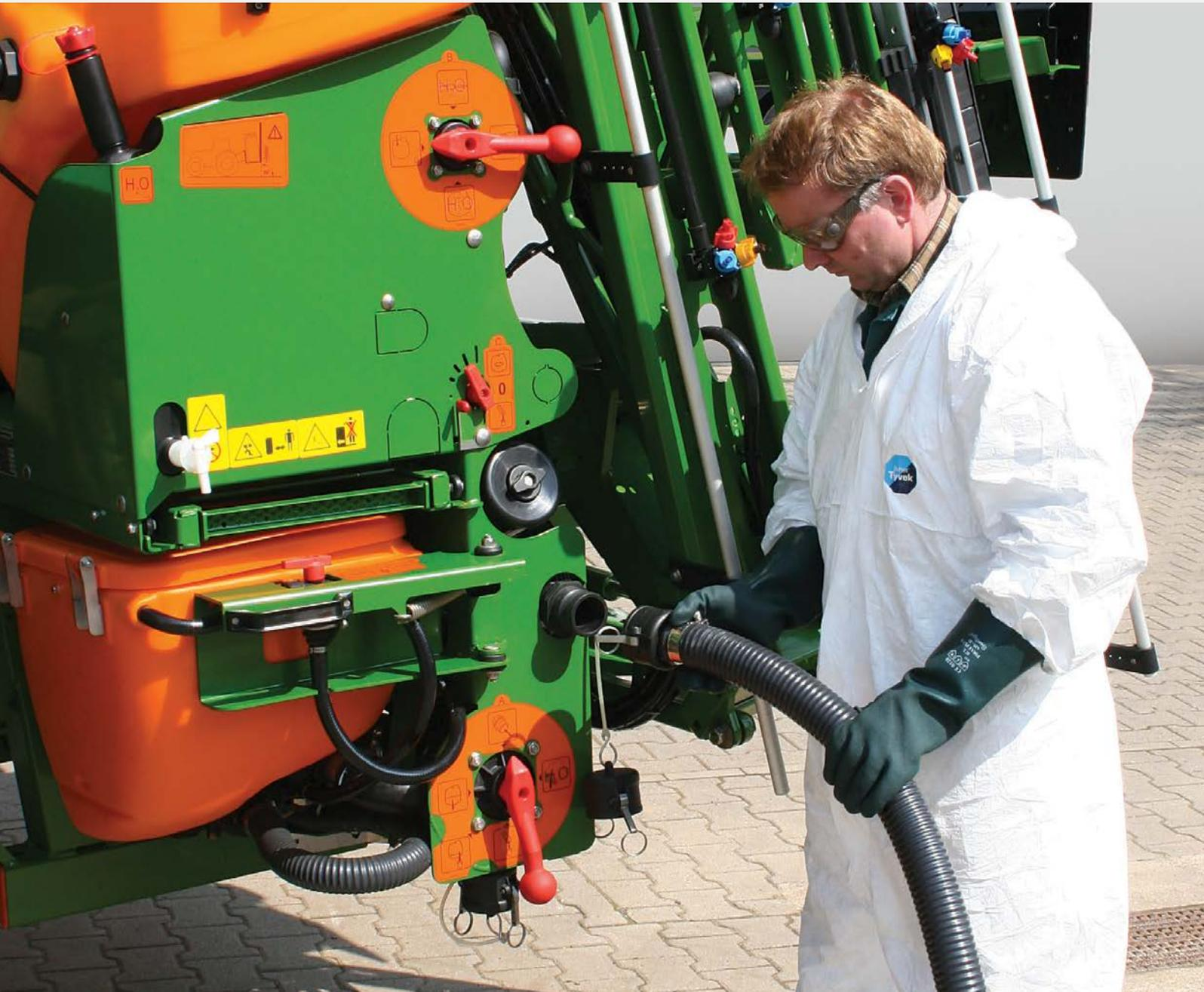
**✔ Befüllung mit dem Saugschlauch**
