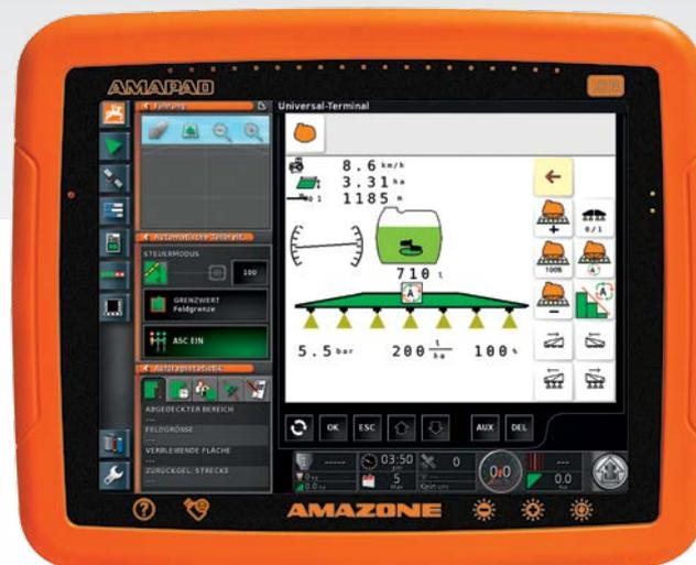
Neben der Teilbreitenschaltung GPS-Switch pro ist mit GPS-Track pro auch eine hochwertige, professionelle manuelle Spurführung serienmäßig installiert. GPS-Track pro lässt sich bis hin zur automatischen Lenkung aufrüsten.
