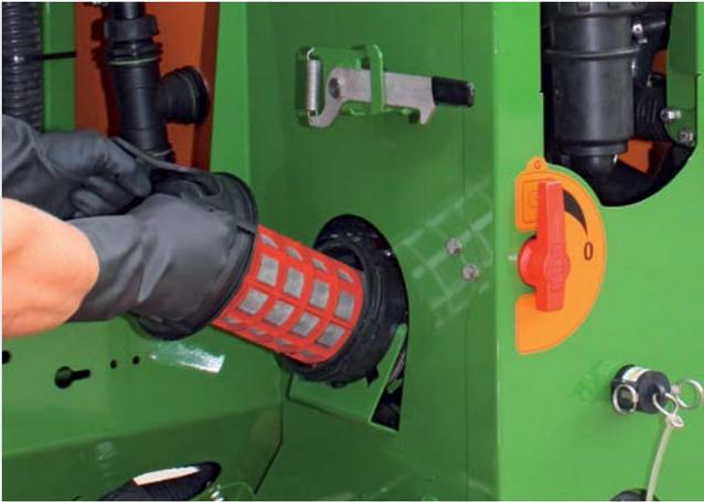
Der Saugfilter lässt sich mit dem einfachen AMAZONE Bajonettverschluss leicht und ohne Spritzflüssigkeitsverluste öffnen.
