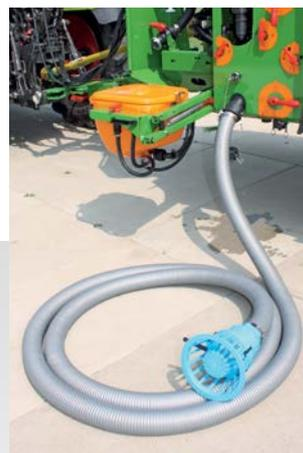
Befüllung über Saugschlauch
