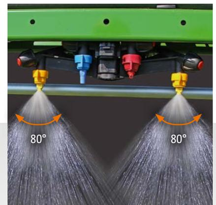
Elektrische EinzeldüSENSCHALTUNG AmaSelect mit 4-fach-DüSENTRÄGER und 50 cm bzw. 25 cm DüSENABSTAND
