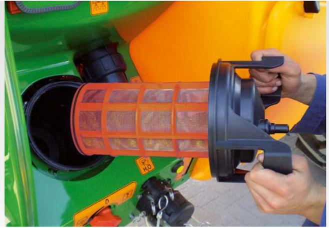
Der Saugfilter kann bei voller Maschine ohne Spritzflüssigkeitsverlust geöffnet werden.
