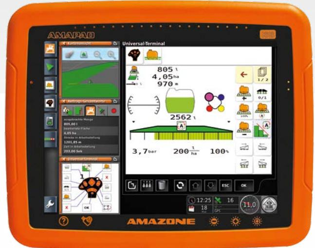
Neben der Teilbreitenschaltung GPS-Switch pro ist mit GPS-Track pro auch eine hochwertige, professionelle manuelle Spurführung serienmäßig installiert. GPS-Track pro lässt sich bis hin zur automatischen Lenkung aufrüsten.
