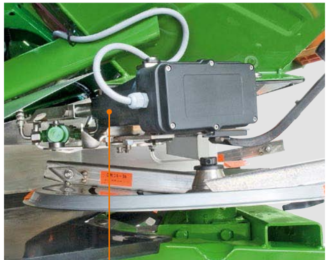
Robuster elektrischer Stellmotor für Dosierschieber
