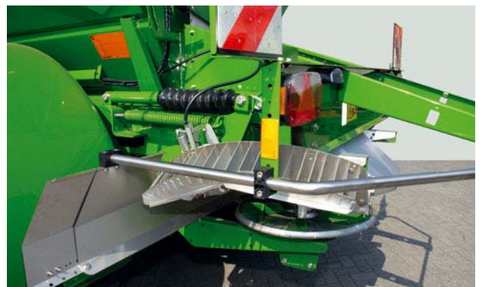
Grenzstreusystem Limiter hochgeklappt für das Normalstreuen
