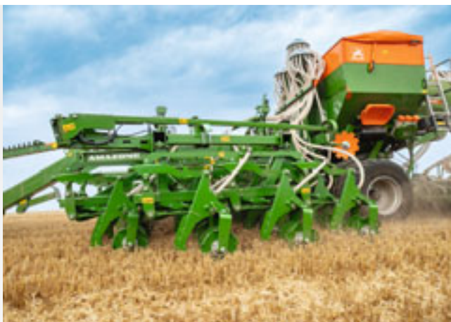
AMAZONE Primera DMC — высокопроизводительная сеялка для прямого посева
