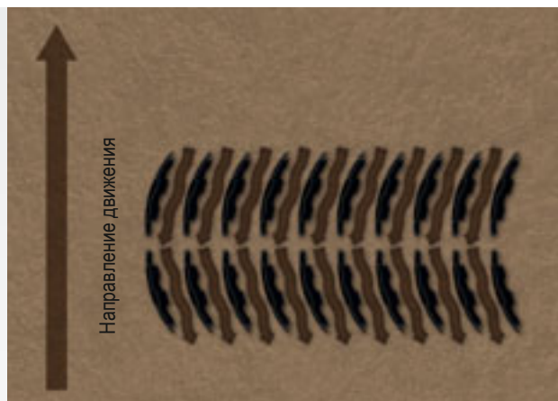
V-образное расположение дисков в два ряда с потоком почвы внутри машины (схематическое изображение)
