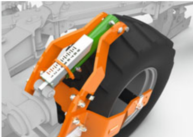
Хорошо видимая шкала на цилиндре глубины обработки
