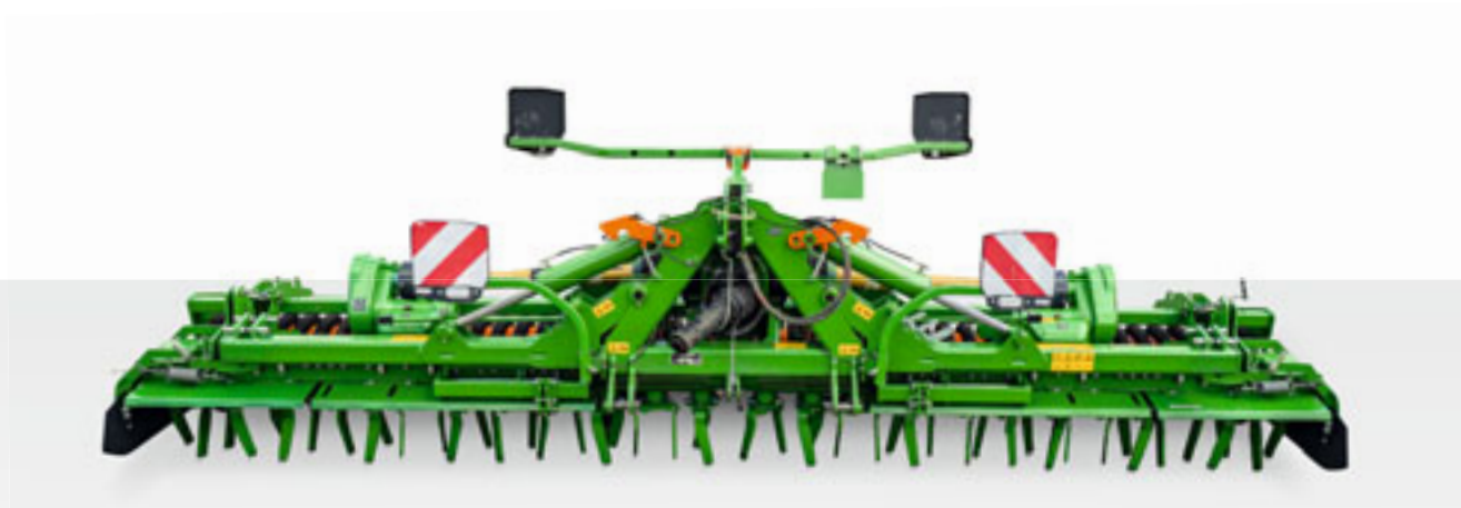
KE 6002-2 400 с 4 держателями зубьев на метр ширины захвата
