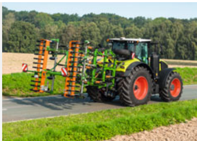
Складной Cenio 5000-2 с предупреждающими знаками и освещением для безопасной транспортировки по дорогам
