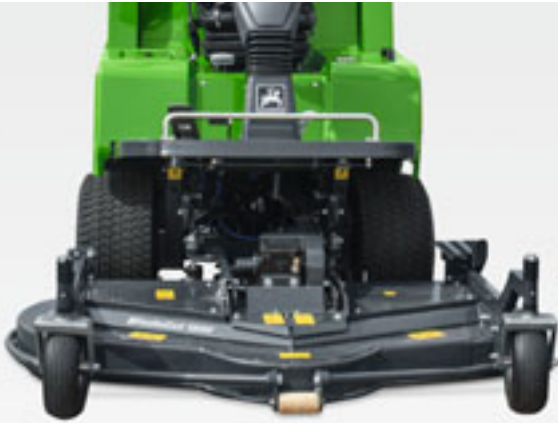
ProfiMower с серповидной косилочной декой BladeCut 1800
