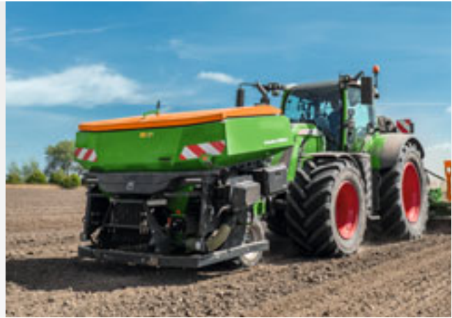
Фронтальный бункер FTender 2200 для внесения удобрений при посеве кукурузы
