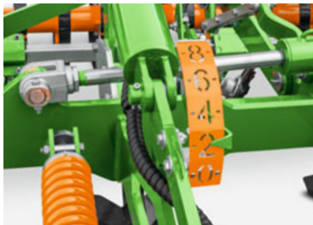
Серийная гидравлическая настройка глубины обработки с помощью легко читаемой шкалы
