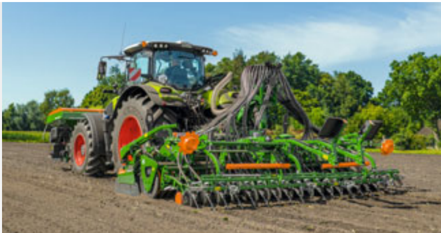
Avant 4502-2 с ротационной бороной 4502-2 и 36 однодисковыми сошниками RoTeC
