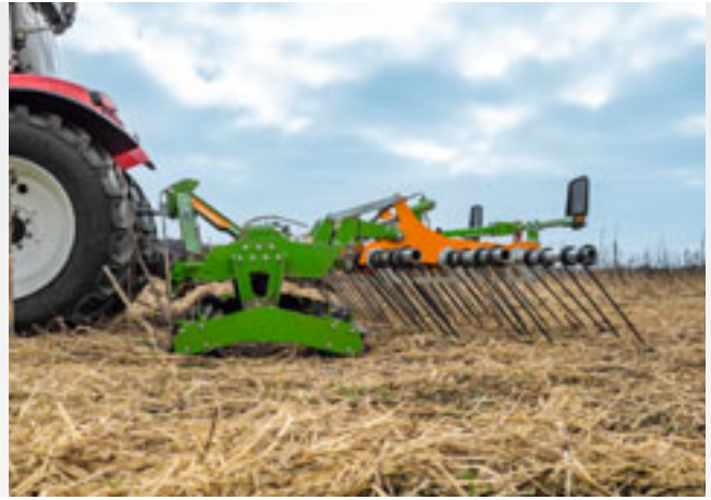
Трёхрядный штригель, помимо прочего, обеспечивает улучшенное распределение соломы после уборки комбайном
