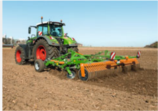
Сеніо 5000-2 Super с опциональными опорными колесами и резино-клиновым катком с шинами Matrix KWM 600
