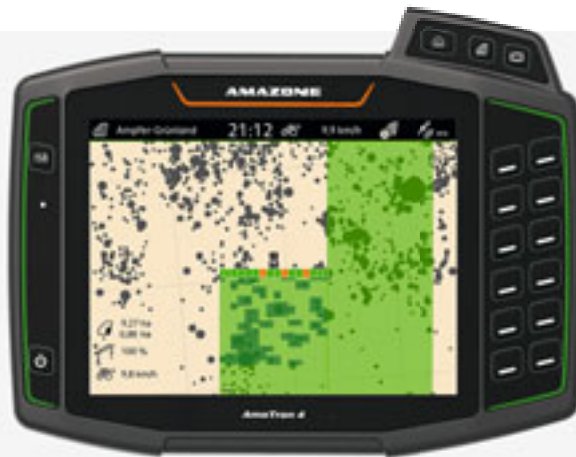
AmaTron 4 во время точечной обработки щавеля. Дополнительная иллюстрация обработанной площади (0,86 га).
