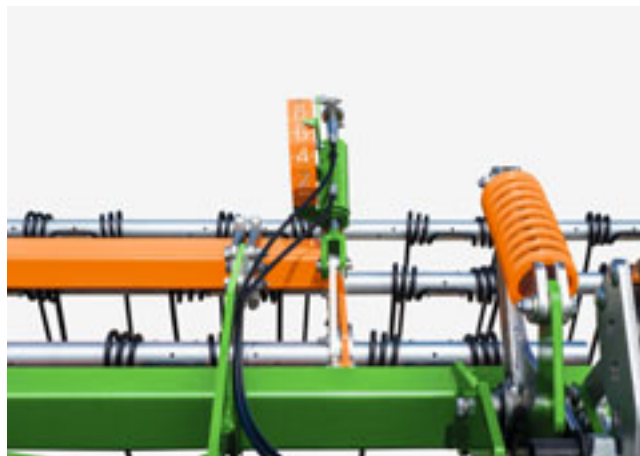
Трехрядный стригель регулируется полностью гидравлически из кабины
