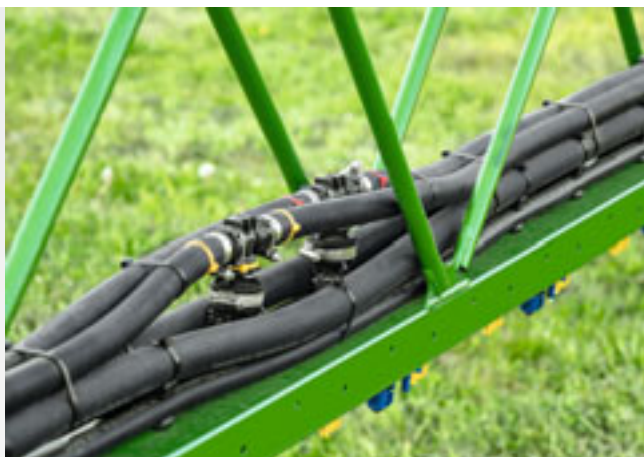
2 трубопровода опрыскивания для применения с дополнительными средствами или без них
