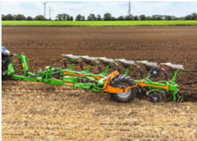
Благодаря прочной трубе рамы Tyrok сохраняет постоянную глубину обработки по всей ширине захвата
