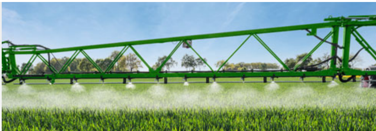
Пульсирующий режим работы форсунок для регулирования нормы внесения независимо от давления
