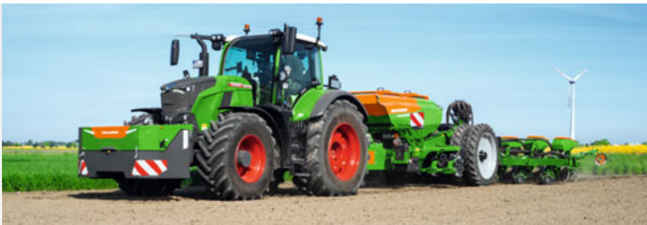
Precea-TCC с фронтальными звездообразными очистителями и сдвоенными шинами
