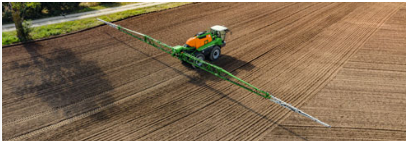
Pantera 4504 для довсходовой защиты растений – EasyTram обеспечивает виртуальную довсходовую маркировку
