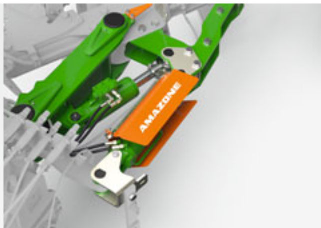
Опциональная гидравлическая регулировка первой борозды
