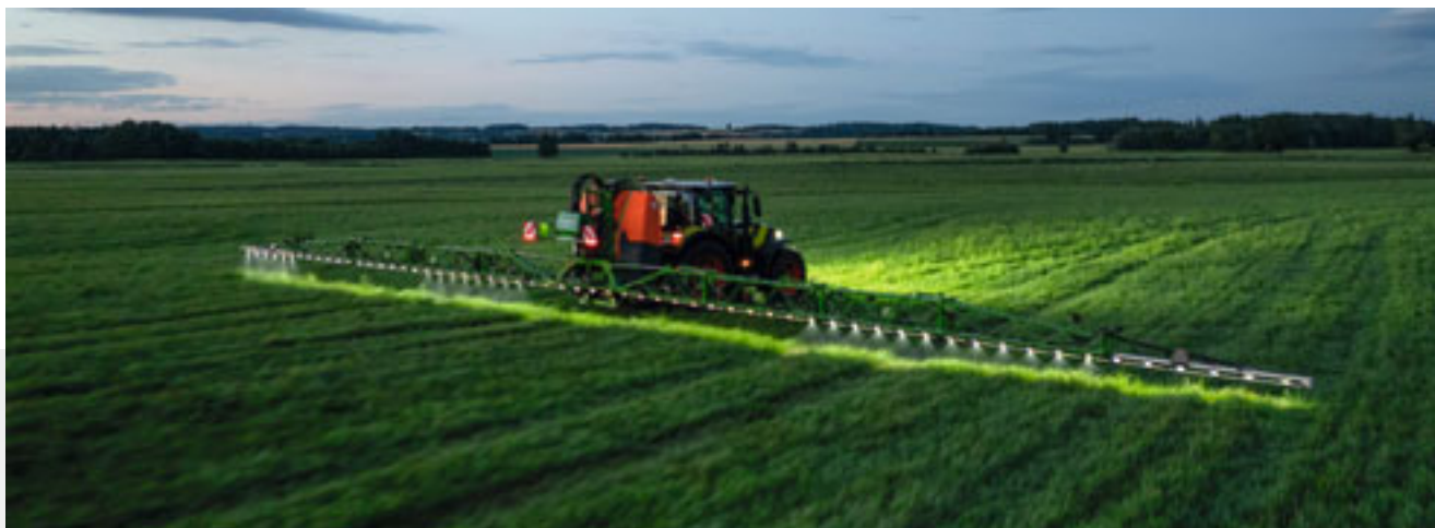
Обработка зараженной площади с помощью опрыскивателя с функцией точечного опрыскивания. На фото: AMAZONE UF 2002.
