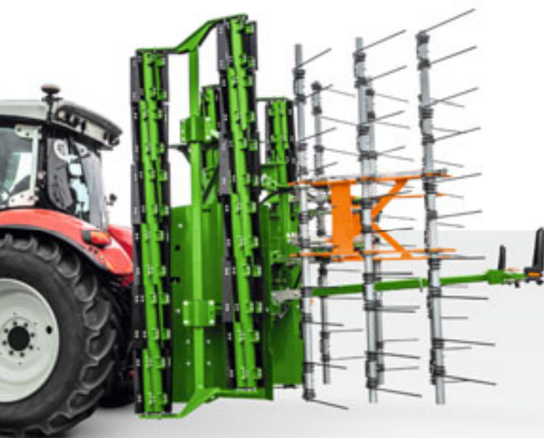
Двухсекционная система складывания обеспечивает быструю смену полей
