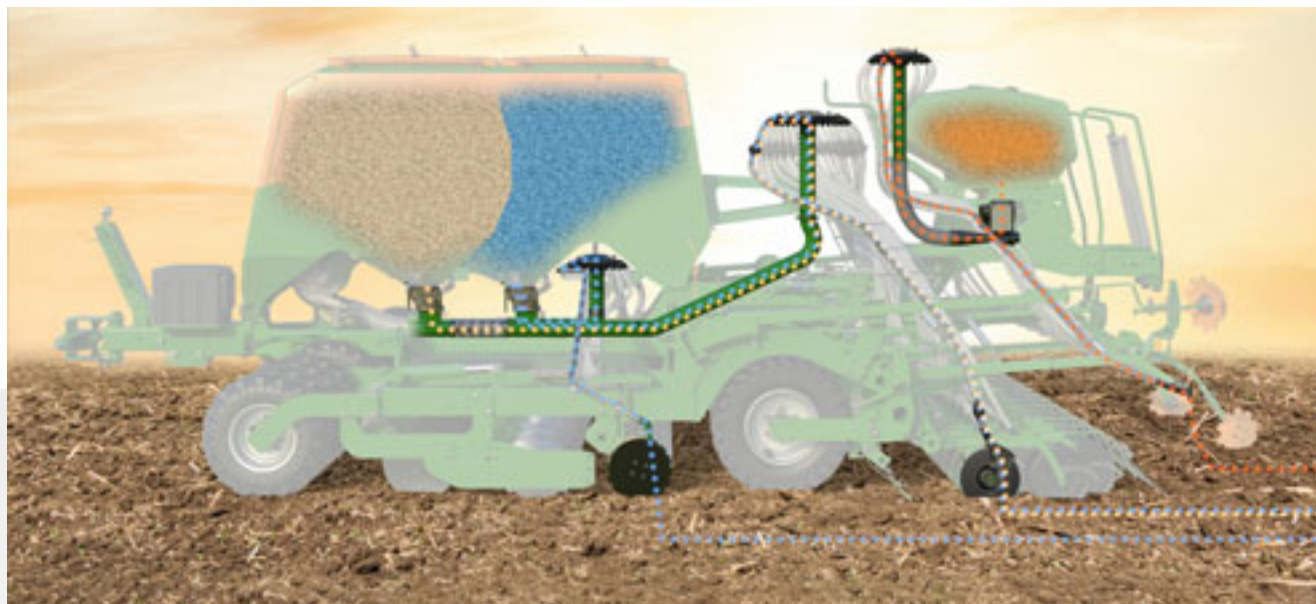
Концепция бункера и распределителя на прицепной посевной комбинации Cirrus с системой Triple-Shoot
