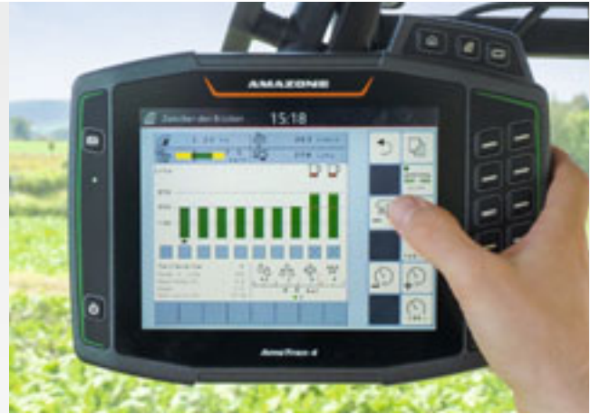
Ручная регулировка нормы внесения по секциям
