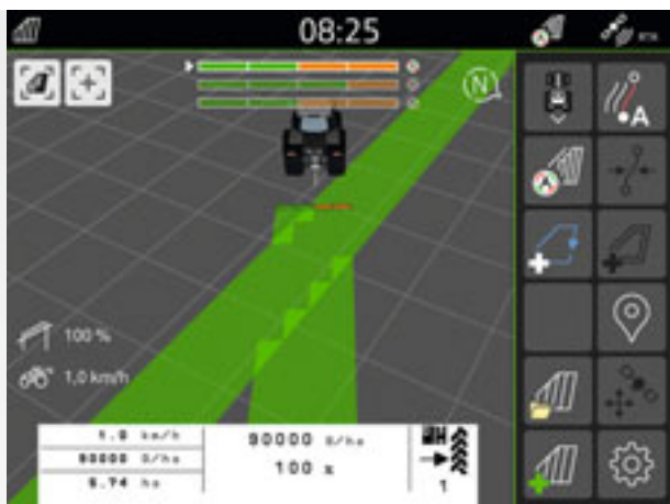
Система включения отдельных рядов для линейки продукции Preseа
