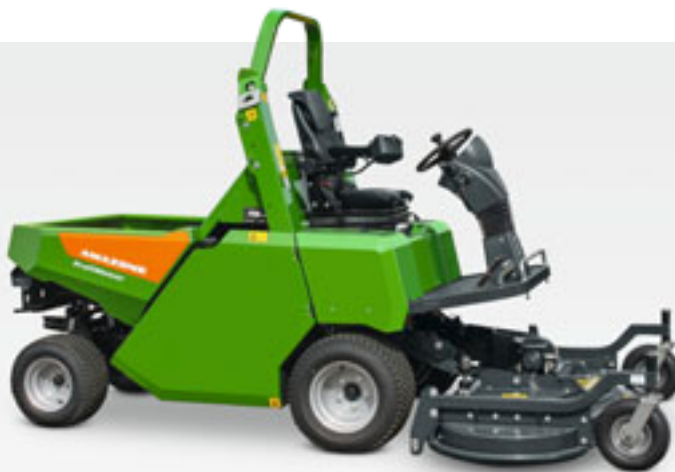
ProfiMower с серповидной косилочной декой BladeCut 1800
