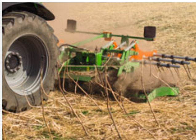
Интенсивное измельчение стеблей подсолнечника двойным режущим катком
