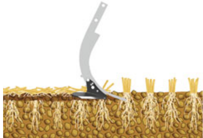
Новая лапа с бритвами 360 позволяет проводить поверхностную обработку и срезание органической массы в положении 1.
