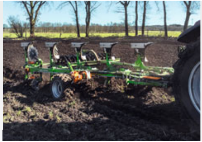
Teres 200 S с боковым опорным колесом для оптимальной вспашки по границе поля
